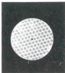
图 7 实验采用的 反射片标靶
